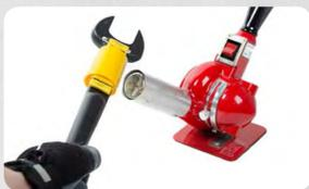
Appliquez un lien de la pellicule thermorétractable sur un point de fixation qui utilise le ruban à guipage rapide. Appliquez la pellicule à l'aide d'un pistolet thermique jusqu'à ce qu'elle soit complètement rétrécie. Ne brûlez pas le lien de la pellicule thermorétractable.
