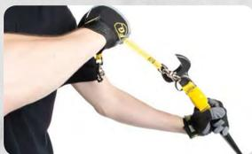
Laissez refroidir le lien de la pellicule thermorétractable pendant 5 minutes avant de l'utiliser. N'oubliez pas de toujours inspecter la connexion avant chaque utilisation pour détecter des dommages ou des irrégularités qui pourraient l'affecter.
